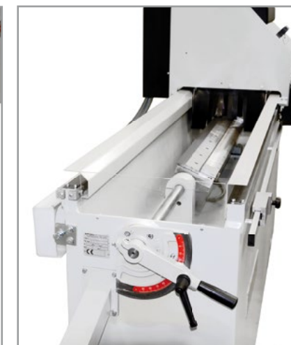
Leva rotazione del piano elettromagnetico 0°/90°
